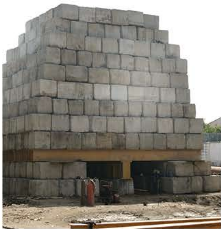
右上: 轴向压缩静载荷试验中使用的配重
