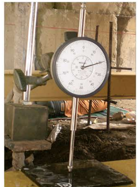
前三: 施加荷载和测量桩移动所需的设备。
