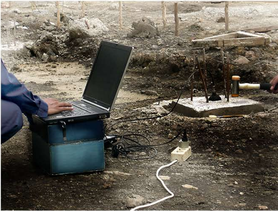
左：桩完整性检测的典型程序。
